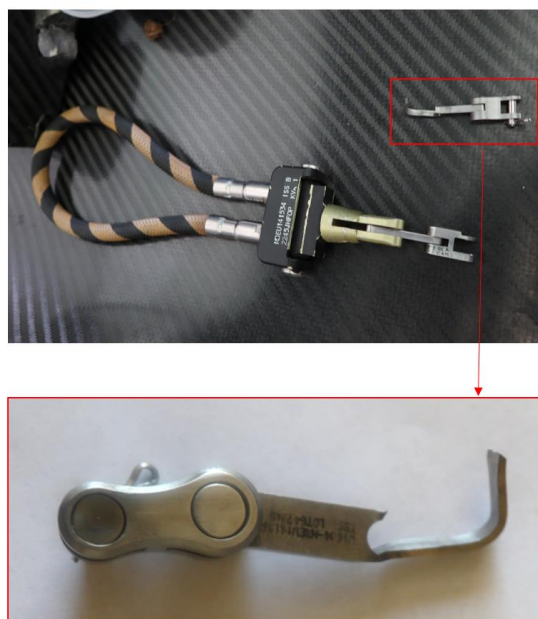
Figure 9 : détail de la poignée et de la biellette du siège arrière
